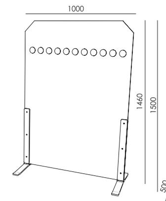
Un module est composé de deux pieds autoportants et d'un vitrage avec bande de visualisation.
