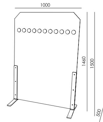
Un module est composé de deux pieds autoportants et d'un vitrage avec bande de visualisation.
